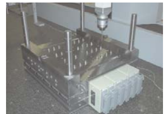
Gorąca połówka na maszynie pomiarowej
