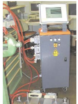
Testowanie połączeń elektrycznych gorącej połówki z zastosowaniem Z123/...
